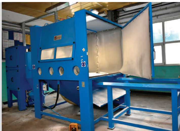
Kabina do obróbki ścierno-erozyjnej detali, tzw. piaskarka.
