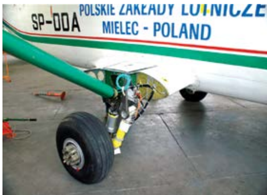
Nowe główne podwozie z amortyzatorem adaptacyjnym do samolotu M28 SKYTRUCK
