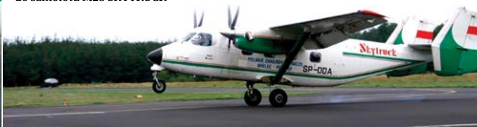
Nowe główne podwozie z amortyzatorem adaptacyjnym do samolotu M28 SKYTRUCK
