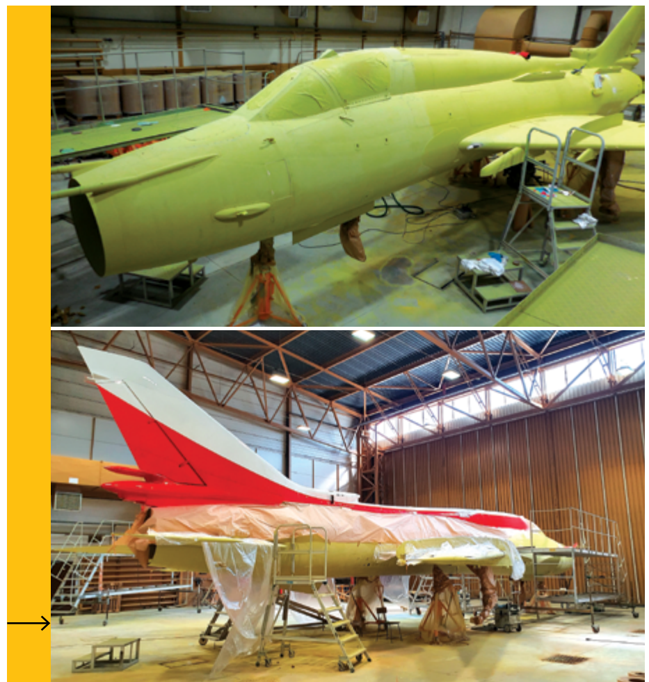
Su-22 po nałożeniu gruntu (od góry) Malowanie barw Bydgoszczy (poniżej)
