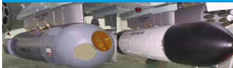
Rys. 1.2. Zasobnik z stacją radiolokacyjną, oraz zasobnik Litening
