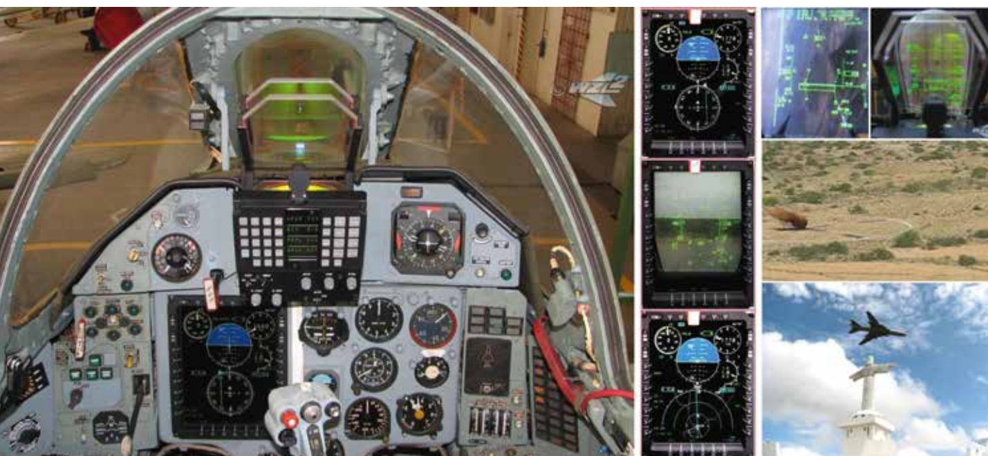
Rys. 1.5. Kabina zmodernizowanego samolotu SU-22 dla Sił Powietrznych Angoli Przykłady zobrazowań na wyświetlaczu MFCD, HUD, Loty poligonowe i pokazowe
