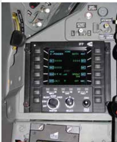
Pulpit PS-CIT-01 zabudowany na samolocie MiG-29M Polskich Sił Powietrznych
